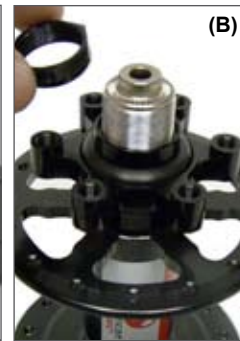
B. Remove adjuster nut.
